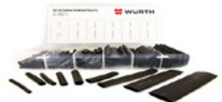
Reticulante por radiación de calor base poliolefínica relación 2:1. Variación después de la contracción 3%. Temperatura de contracción a partir de 90°C. Rigidez 19 Kv/mm-min. Auto extingible, no se funde. Resiste a disolventes y químicos.
