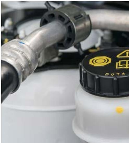
Los líquidos de frenos convencionales **DOT** soportan temperaturas de ebullición de 205 °C (DOT 3), 230 °C (DOT 4) o 260 °C (DOT 5).
