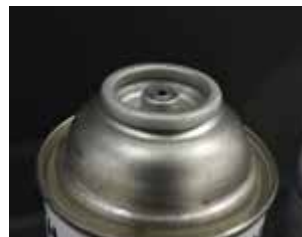
Válvula dañada por exceso de presión.
