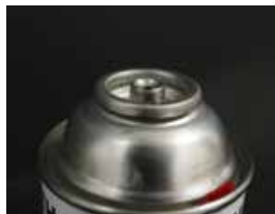
Válvula dañada, por desgaste en el ponchador.
