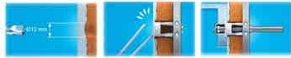
**Taquete (anclaje) especial para tablaroca con anclaje a la estructura metálica de la pared.**
