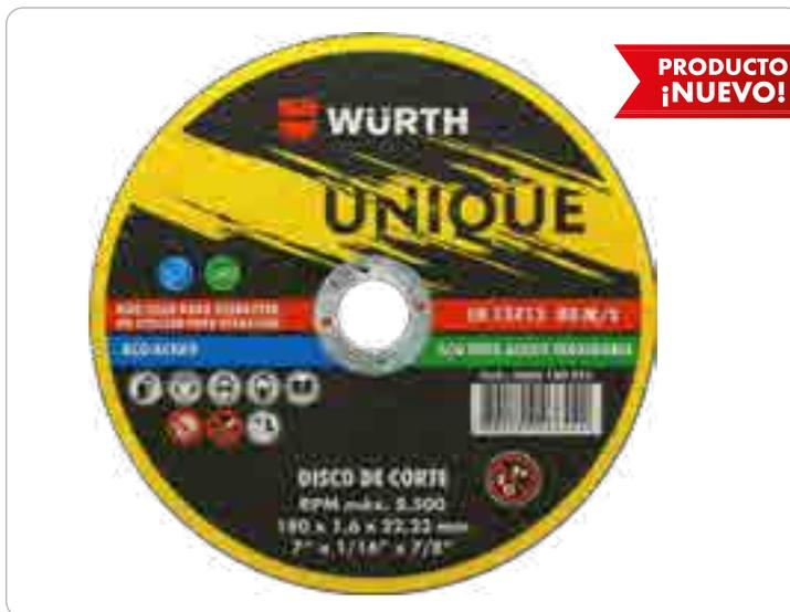
**Disco abrasivo de corte, desarrollado para cortes en acero inoxidable, acero al carbón, metales ferrosos y no ferrosos, con excelentes resultados en perfiles, tubos, vigas y piezas macizas. Se utiliza en todo tipo de máquinas portátiles, como son amoladoras radiales y así como en máquinas estáticas en las medidas de 10", 12" y 14", siempre respetando las velocidades periféricas recomendadas.**
