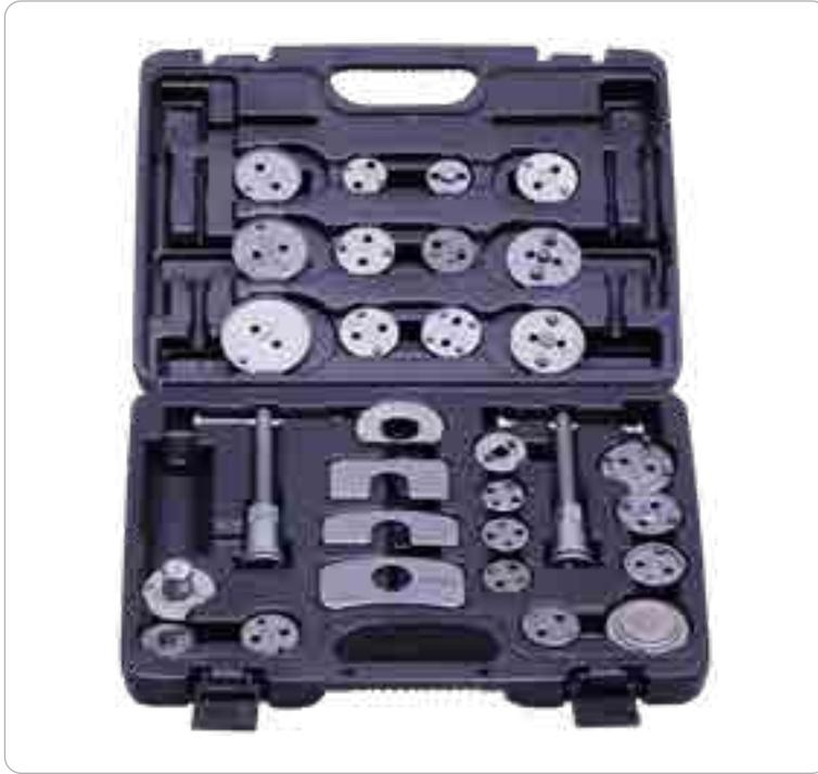
**Conjunto de opresores para comprimir los pistones de los calipers de freno, adaptándose a una gran parte de modelos y marcas de vehículos que existen en el mercado.**
